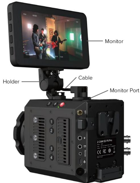
云台允许大约 170 度垂直旋转和 360 度水平旋转。
